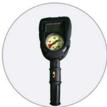
电子报警器及压力表：为一体化设计，置于使用者前胸部；报警压力  $5.5 \pm 0.5 \text{ MPa}$ ，连续声响时间至少应以  $90 \text{ dB}$  (A)的声强持续  $\geq 15 \text{ s}$ ，带有呼救器功能；电气元件的防爆性能应符合Ex ia IIC T4 级的规定，IP67 防尘防水等级，
