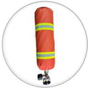
碳纤维气瓶水容积 9L 带有压力表显示,外套带反光标识，标志符合国家消防救援局标准。气瓶阀为右手设计，自锁功能采用整体按压式设计，方便穿戴手套操作，接口为可拆卸式快速接口。
